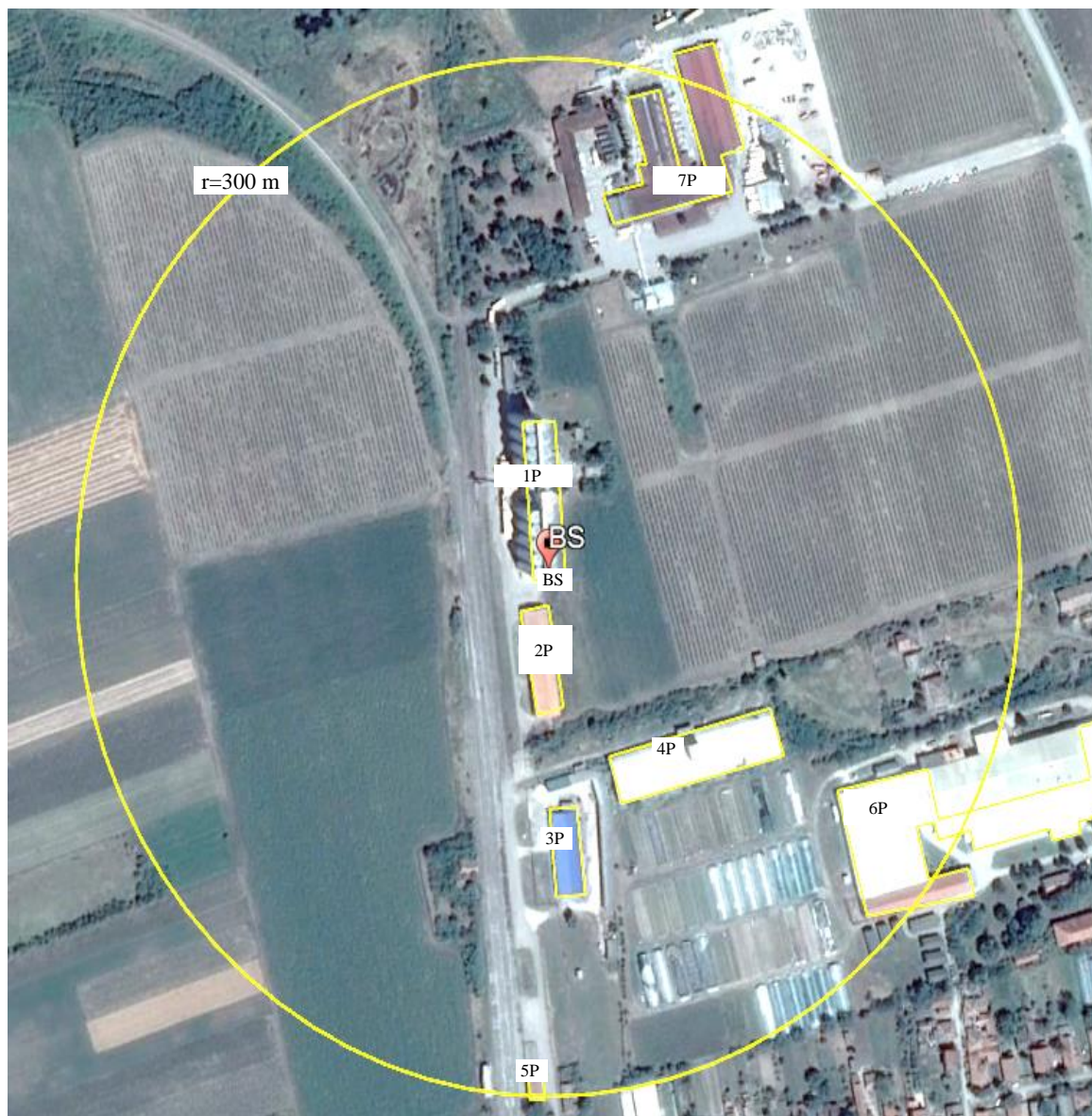
Slika 2.4. Raspored objekata u zoni povećane osetljivosti 19S Oznake: nS = Stambeni objekat; nP = Poslovni objekat;;
